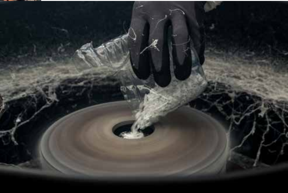
Ci-contre : Fabrication de la laine Polyfloss, laboratoire Ndao Hanavao, Antananarivo, 2019
